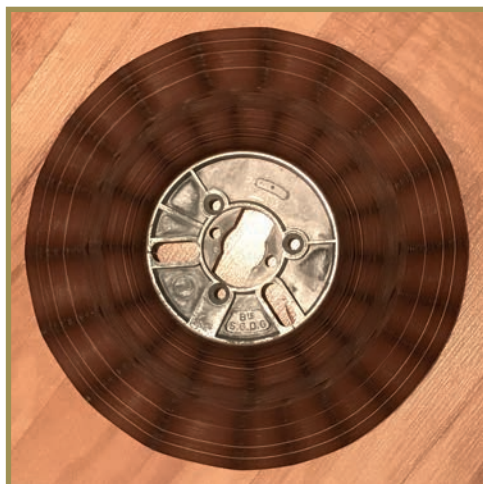
A gauche : Traitement d'une bande Ampex de 1980 atteinte de "Sticky Shed Syndrome" : Chauffage dans un four spécial avec contrôle de température, afin d'en extraire l'humidité et ainsi éviter qu'elle ne colle et perde son oxyde sur les guides et les têtes de lecture.
