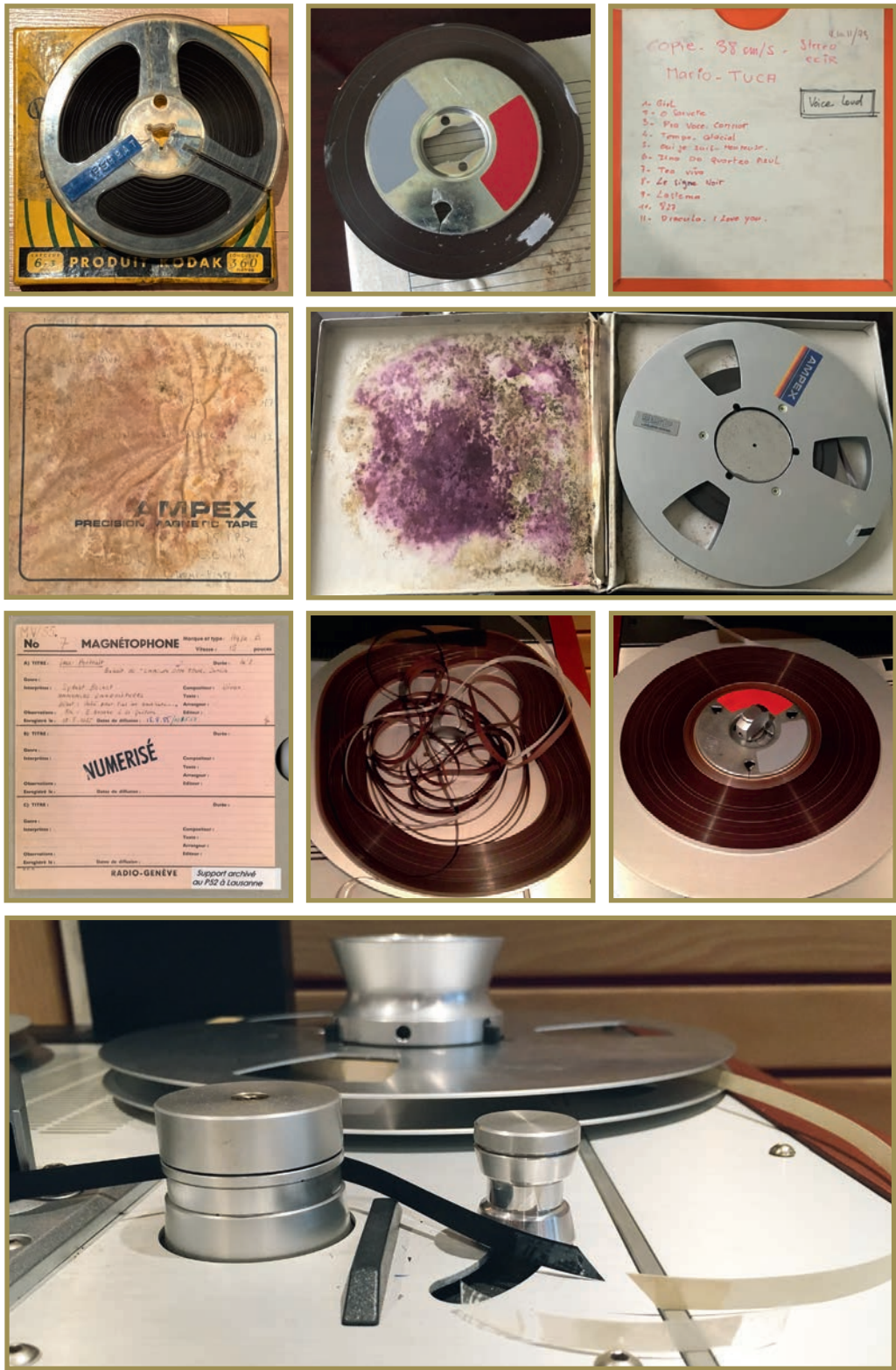
En haut : Différentes bandes magnétiques que nous avons sauvegardées, dont certaines avec des moisissures, et rembobinage manuel d'une bande. En bas : L'une des dégradations les plus courantes : les collages se dessèchent et lâchent, et doivent être impérativement remplacés pour permettre la lecture de la bande.
