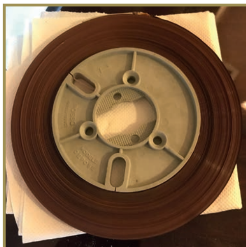
Bande magnétique de 1962 sauvée in extremis suite à une exposition prolongée à l'humidité. Le noyau a été remplacé et les moisissures enlevées. Cette bande a pu être sauvegardée. (photos avant / après)
