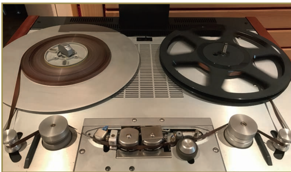
Déformations sur une bande magnétique Pyral de 1964, laquelle ne passe plus devant la tête de lecture de manière uniforme, ce qui provoque des irrégularités de niveau sonore.
