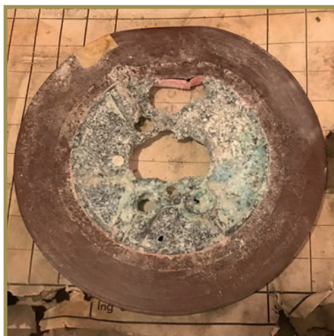
Bande magnétique de 1962 sauvée in extremis suite à une exposition prolongée à l'humidité. Le noyau a été remplacé et les moisissures enlevées. Cette bande a pu être sauvegardée. (photos avant / après)
