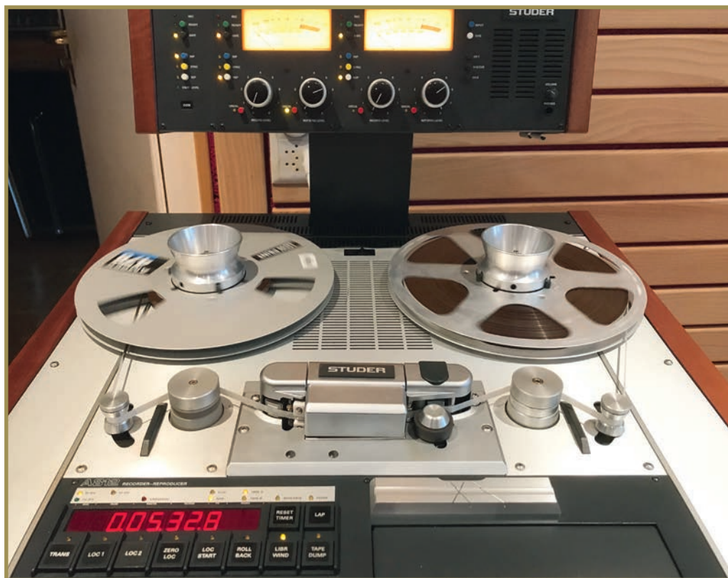
Sauvegarde d'une bande magnétique, après réglage de la tête de lecture.
