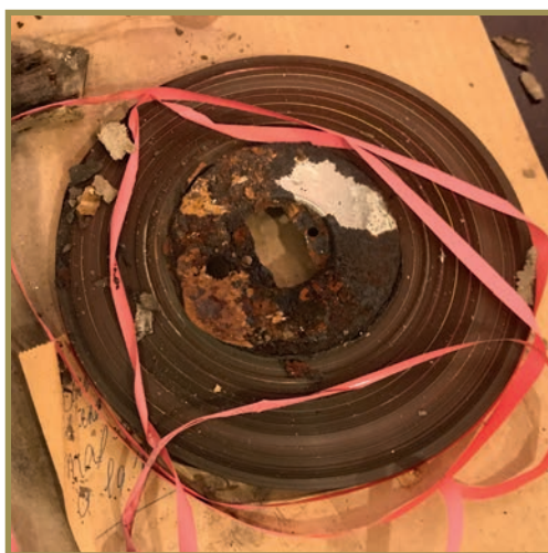
Bande magnétique de 1963 sauvée in extremis suite à une exposition prolongée à l'humidité. Avant de pouvoir sauvegarder cette bande, notre Chef de projets l'a nettoyée et séchée et a remplacé le noyau rouillé. (photos avant / après)
