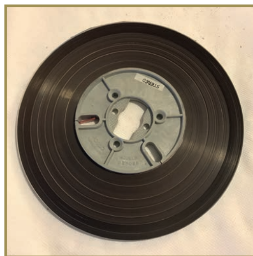
Bande magnétique de 1963 sauvée in extremis suite à une exposition prolongée à l'humidité. Avant de pouvoir sauvegarder cette bande, notre Chef de projets l'a nettoyée et séchée et a remplacé le noyau rouillé. (photos avant / après)
